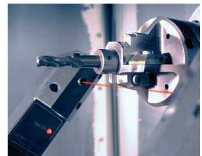
Быстрое выявление микроизноса на резце
