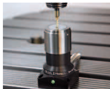
Измерение длины инструмента
