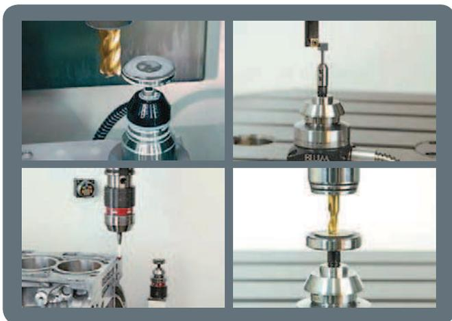
Использование датчиков несложно благодаря программным средствам и не требует специальной продолжительной подготовки специалистов. Циклы измерений инструмента могут легко прописываться в управляющих программах. Также простота измерения инструмента обусловлена возможностью его классификации и определения основополагающих параметров для формообразования деталей.
